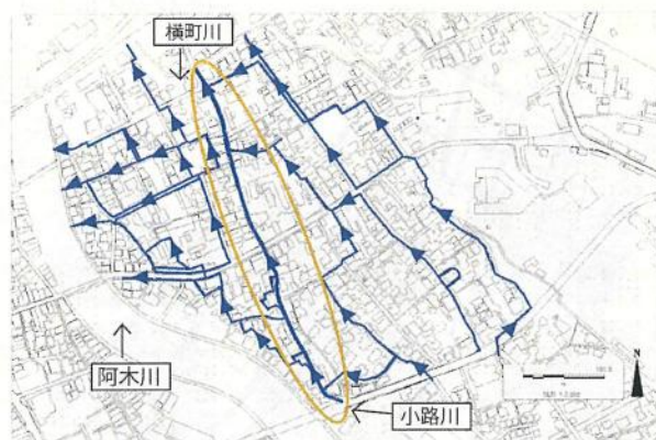
fig5.2 水の流れの方向と小路川の位置
